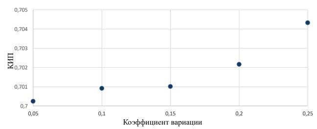
Рисунок 16 — Влияние коэффициента вариации одиночной нити на КИП при 64-х нитях в пучке
