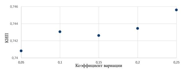
Рисунок 19 — Влияние коэффициента вариации одиночной нити на КИП при 16-ти нитях в пучке
