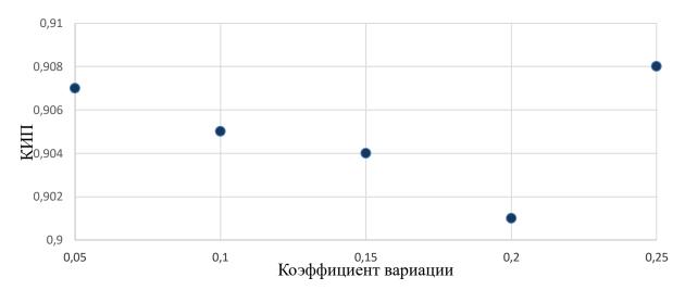
Рисунок 18 — Влияние коэффициента вариации одиночной нити на КИП при 2-х нитях в пучке
