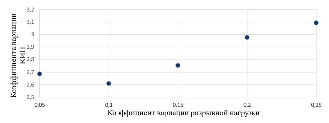
Рисунок 9 — Влияние коэффициента вариации одиночной нити на коэффициент вариации разрывной нагрузки
