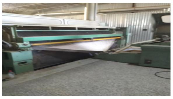
Рисунок 6 – Процесс кардочесания на предприятии «Квест-А». (фото автора, август 2018 г.)
