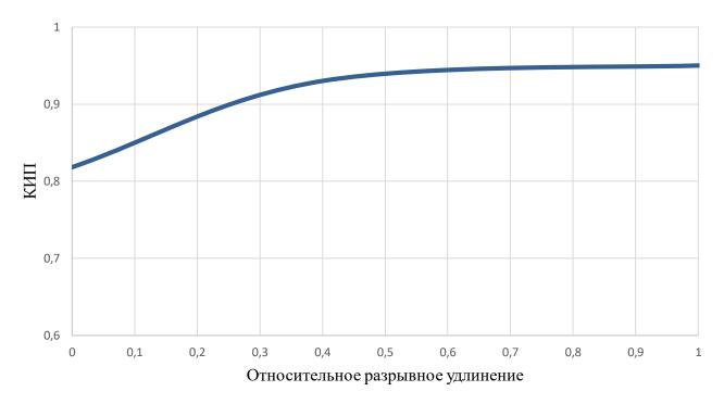
Рисунок 31 — Кривая изменения коэффициента использования прочности в зависимости от величины относительного разрывного удлинения
