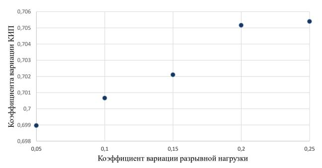
Рисунок 12 — Влияние коэффициента вариации одиночной нити на КИП при 64-х нитях в пучке
