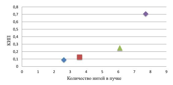
Рисунок 23 — Отношение коэффициента вариации пучка к количеству нитей в пучке
