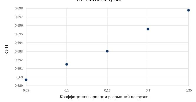
Рисунок 13 — Влияние коэффициента вариации одиночной нити на КИП при 128-ми нитях в пучке
