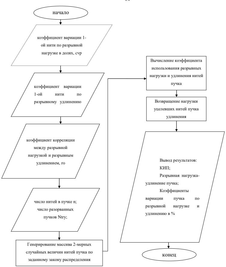
Рисунок 8 — Блок-схема процесса моделирования прочности пучка параллельных нитей
