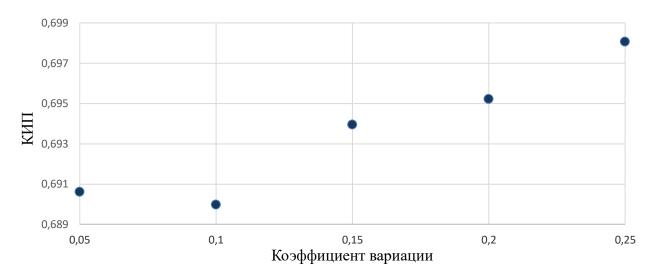
Рисунок 17. Влияние коэффициента вариации одиночной нити на КИП при 128-ми нитях в пучке
