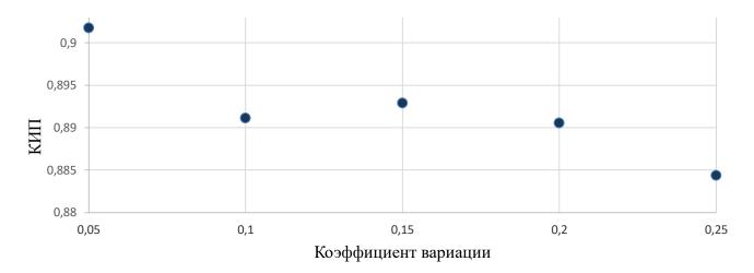
Рисунок 14 — Влияние коэффициента вариации одиночной нити на КИП при 2-х нитях в пучке
