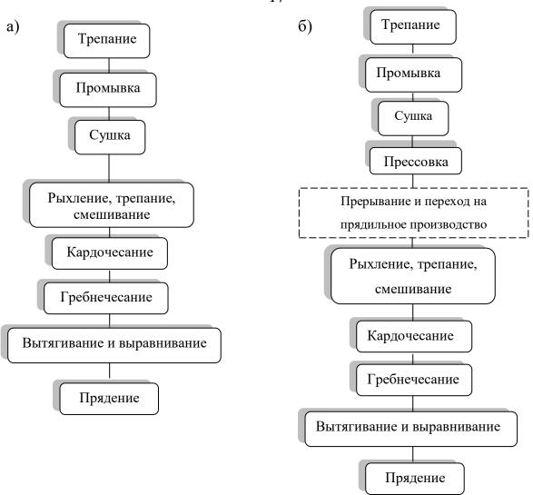
Рисунок 1 — Схема работы предприятия по технологии «немытая шерсть — трикотажная пряжа» и сравнение со стандартной технологией переработки и прядения шерсти:
