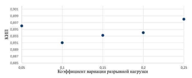
Рисунок 10 – Влияние коэффициента вариации одиночной нити на КИП при
