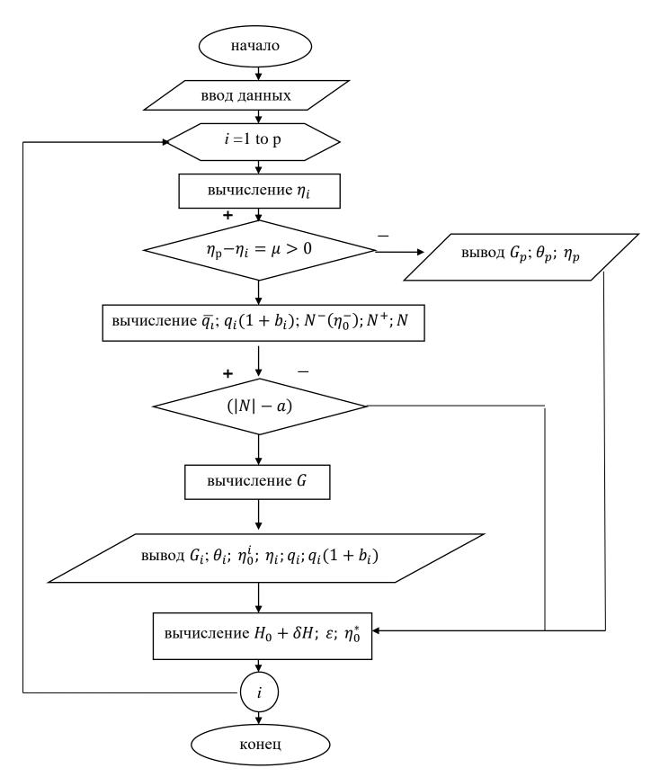
Рисунок 27 — Алгоритм работы автоматизированной системы расчета прочностных характеристик шерстяной трикотажной пряжи, исходя из ее свойств
