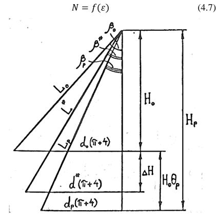
Рисунок 24 — Развертка оси пряди трикотажной пряжи до и после нагрузки На рисунке 24 показана развертка оси пряди трикотажной пряжи до и после нагрузки. Как видно из рисунка 24:
