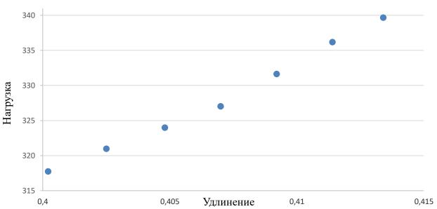
Рисунок 45 — Сравнение «нагрузка-удлинение» восьмипрядного плетеного изделия
