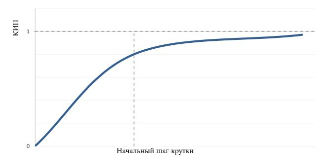
Рисунок 29 — Влияние коэффициента  $\alpha$  на коэффициент использования прочности
