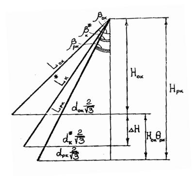
Рисунок 25 — Развертка оси пряди крученой пряжи до и после нагрузки Следовательно, можно записать:
