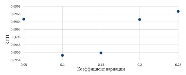
Рисунок 21 — Влияние коэффициента вариации одиночной нити на КИП при 128-ми нитях в пучке.
