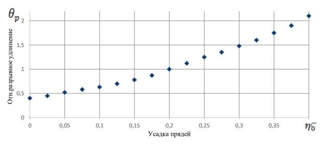
Рисунок 26 – Изменение относительного разрывного удлинения трикотажной пряжи с изменением относительной усадки прядей
