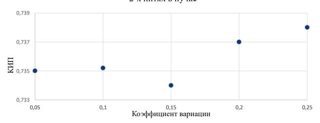
Рисунок 15 — Влияние коэффициента вариации одиночной нити на КИП при 16-ти нитях в пучке
