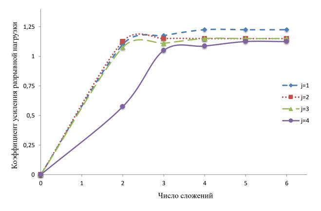
Рисунок 40 — Взаимосвязь коэффициента усиления разрывной нагрузки шерстяной пряжи и числа сложений в процессе крутки
