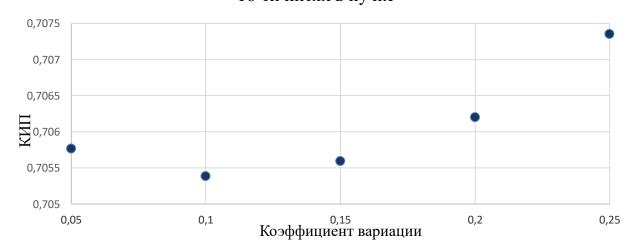
Рисунок 20 — Влияние коэффициента вариации одиночной нити на КИП при 64-х нитях пучке
