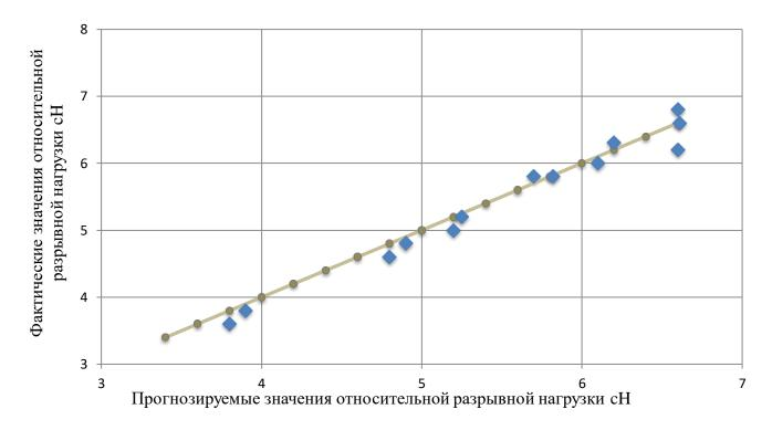
Рисунок 37 — Сравнение прогнозируемых значений относительной прочности
