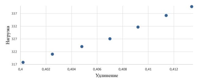
Рисунок 32 — Диаграмма «нагрузка-удлинение» трикотажной пряжи Параметры, характеризующие трикотажную пряжу, приведены в таблице 23.
