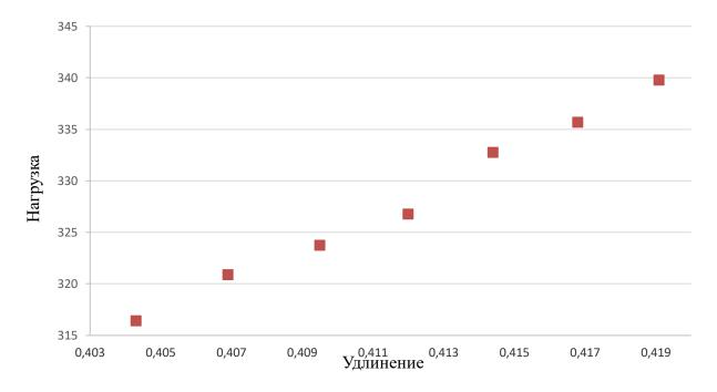
Рисунок 46 – «нагрузка-удлинение» трехпрядного крученого изделия
