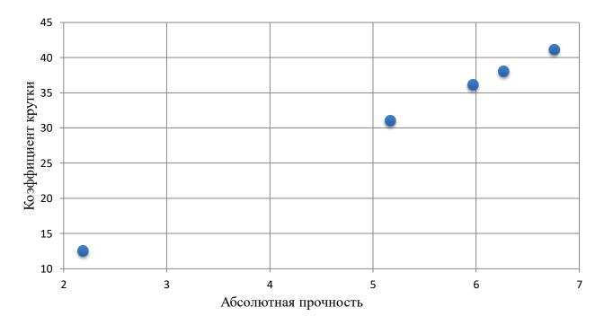
Рисунок 35 — Отношение коэффициента крутки пряжи к абсолютной прочности Разрывную нагрузку крученой пряжи можно подсчитать по формуле:
