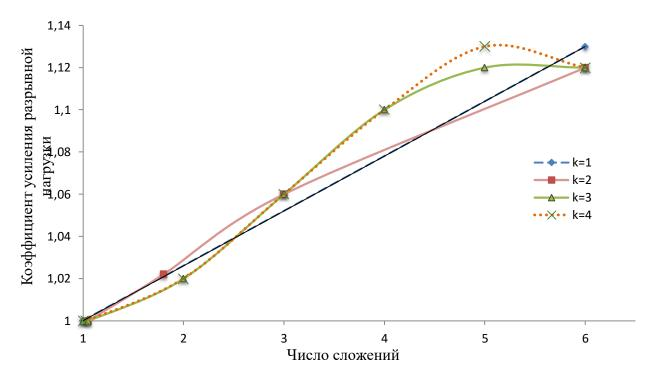
Рисунок 41 — Обратная взаимосвязь коэффициента усиления разрывной нагрузки шерстяной пряжи и числа сложений
